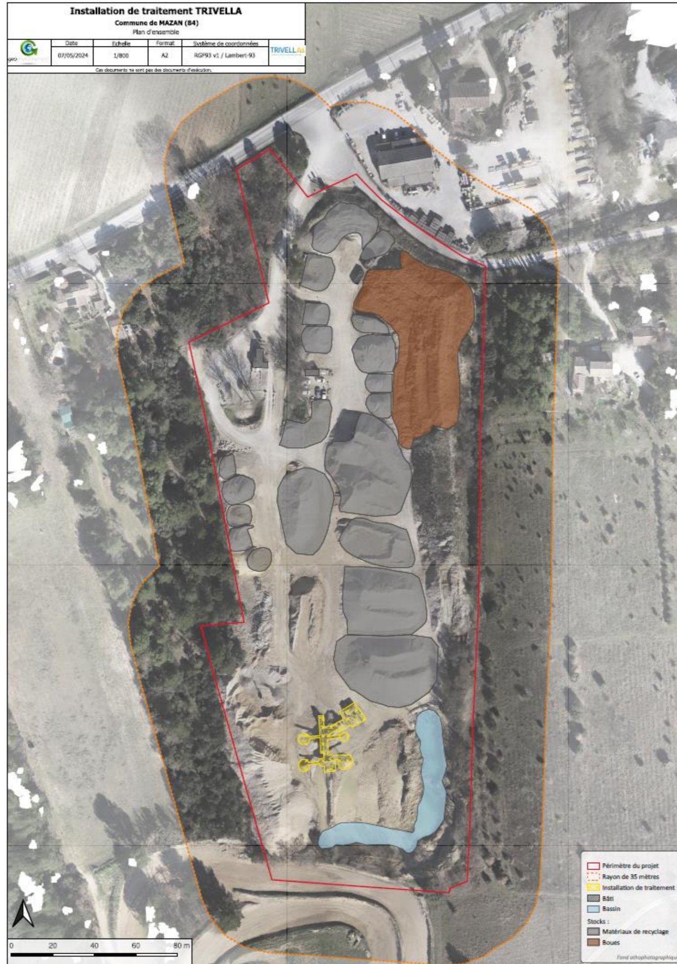
Figure 1. Justification du respect de la distance des 20 mètres vis-à-vis des limites du site
